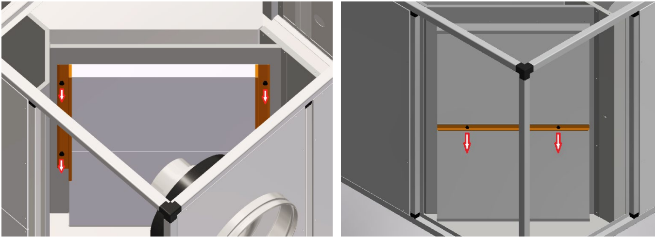
Figura 8 – Secuencia de operaciones para quitar los filtros en las unidades grandes: retirar los retenes del filtro (después de desatornillar los tornillos/perillas de fijación) y quitar los filtros de la cubierta frontal o de los paneles laterales.
